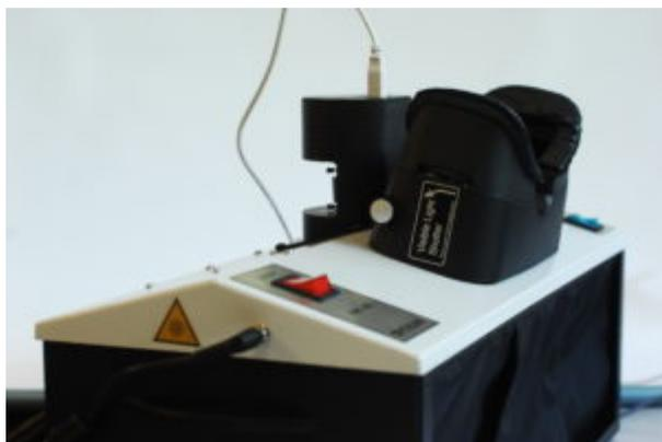
поставки). Безопасность зрения лаборанта обеспечивается как используемым защитным УФ-фильтром, который установлен перед окуляром, так и гораздо более редкой необходимостью наблюдать образец визуально: его прекрасно видно на экране дисплея или компьютерного монитора. УФ-осветитель к аналитическому кабинету снабжен специальными светоизлучающими диодами
